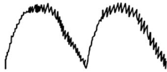
図 2-2 コンデンサのリプル電流波形
